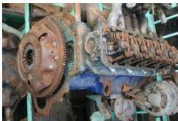
汽油引擎示教台
